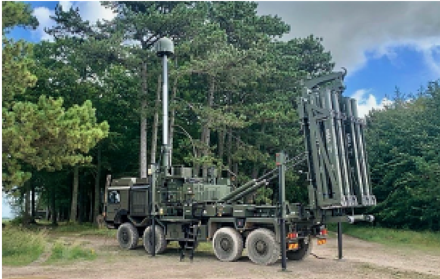
Kurzstrecken-Flugabwehrsystem „Narew“. Eine polnisch-britische Konstruktion zur Bekämpfung von Flugzeugen, Hubschraubern und Raketen. Bestellt sind 23. Die ersten beiden sind bereits im Einsatz.
