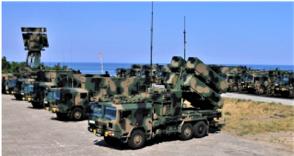
Die polnische Küstenverteidigung verfügt über eine mobile Batterie, ausgestattet mit norwegischen NSM-Seeziel-Marschflugkörpern mit einer Reichweite von bis zu 180 Kilometern.
